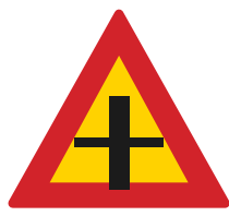
A-6a skrzyżowanie z drogą podporządkowaną
